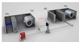
Beimischung von warmem Wasser/Glykol-Gemisch, sodass die Eintrittstemperatur des Wasser/Glykol-Gemisches bei Eintritt in das WRG-Fortluft-Register eine minimale Temperatur von  $-1^{\circ}\text{C}$  bis  $-2^{\circ}\text{C}$  nicht unterschreitet. Der Warmwasser-Nachwärmer muss nicht auf die volle Leistung bei der tiefsten Außentemperatur dimensioniert werden, da die WRG-Leistung ab der Einfriergrenze konstant bleibt.
