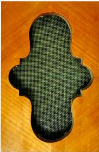
Netz aus Leinenfäden (5 Fäden pro cm), grün gezeichnet, u.a. im Klavierbau um 1800 zum Verschließen von Durchlöchern verwendet. Links, in ursprünglichem Zustand erhalten. Rechts, ein wenig entsprechender Ersatz mit Meterware in Baumarktqualität als Beispiel einer unrestauratorischen Behandlung.
