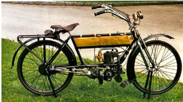
rs. Fabrique National des Armes de Guerre (F) 1909, 1-Zylindermotor, 4-Takt 2,5 rs; erstes Motorrad der Welt mit Kardanwelle auf Hinterrad.
