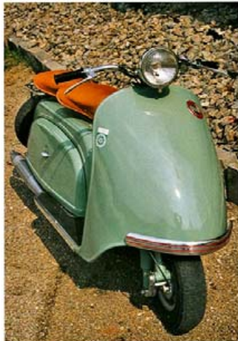
Lobner 125 Roller, 1936; 125 ccm, 1-Zylindermotor, 2-Takt, 6,8 rs
