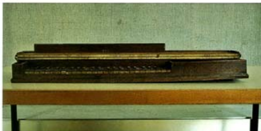
Clavichord, 18. Jh., jenseits des Endes seiner Tage. Der Saitenzug hat das Instrument unspielbar verformt.
