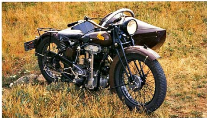
Praga Motorrad mit Beiwagen, (CZ) 1928; 1-Zylindermotor, 500ccm, 4-Takt, Königswelle, ca. 14 rs
