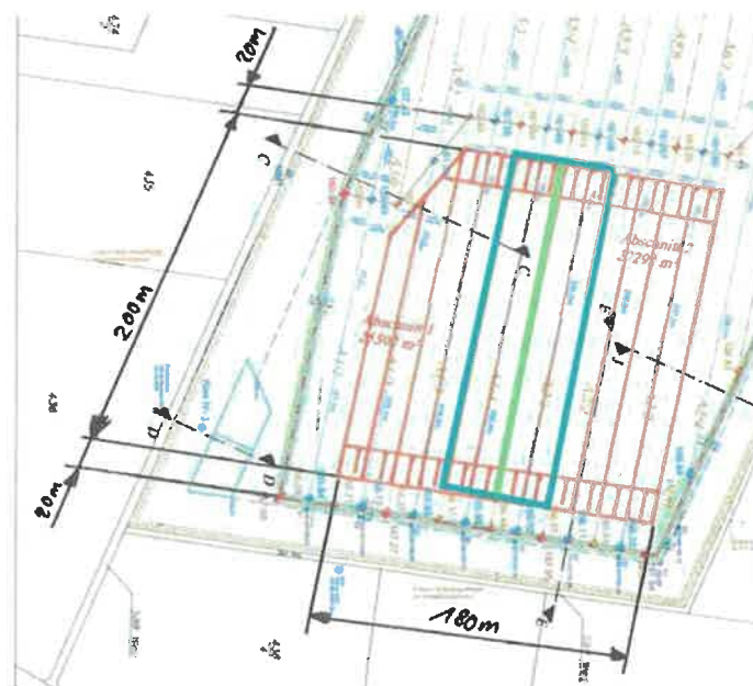
Abb. 1: Ausschnitt Grundriss geplante Ausdehnung Asbestkompartiment mit beispielhaftem offenen Abschnittsbereichen (blau).
