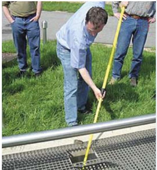
Entnahme einer Schlammprobe
